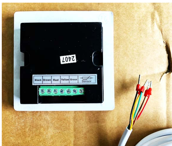
※コントローラー裏面/配線ケーブル
