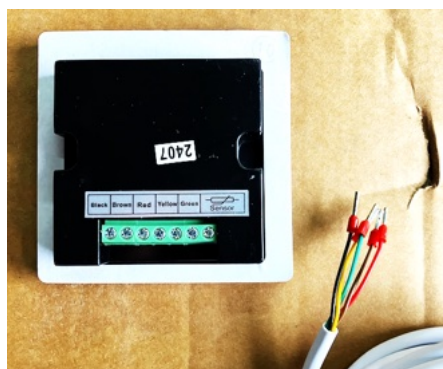
※コントローラー裏面/配線ケーブル
